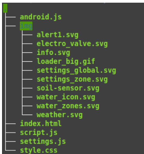
Rysunek 5: Struktura plików aplikacji internetowej wyświetlanej osadzonej w komponencie WebView pakietu Android
